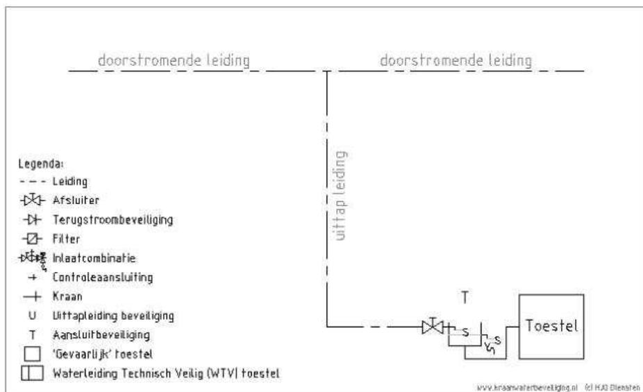
Aansluiting van een Bedpanspoeler/pospoeler. De Bedpanspoeler is niet voorzien van een vrije uitloop met injector (AD); niet voorzien van het Kiwa-merk Waterleiding Technisch Veilig (WTV) of de beveiliging is onbekend.
